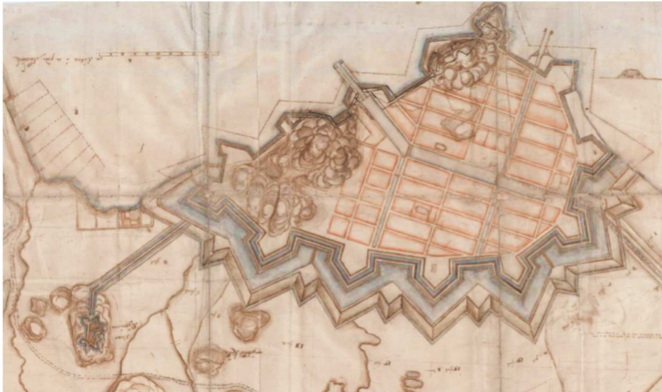
Illustrationen visar delar av den föreslagna befästningsanläggningen. Här syns stora ryssåsen med skans i sydväst, nuvarande Skansen Kronan, dess förbindelse med den befästa staden via kaponjären, utsnitt ur ritning av Erik Dahlbergh år 1639, Krigsarkivet 080b.
